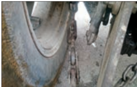
شکل ۳-۷۸- تنظیم زنجیر مهار کننده
