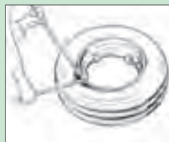
شکل ۲۵-۵ جدا کردن تایر از رینگ یک تکه
