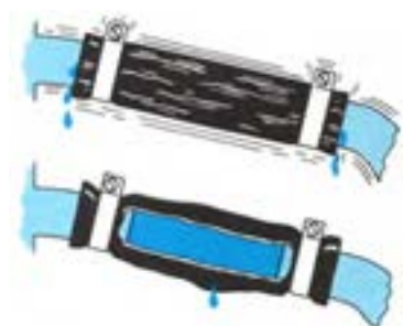
شکل ۵۶-۵- نشستی از شیلنگ ها
