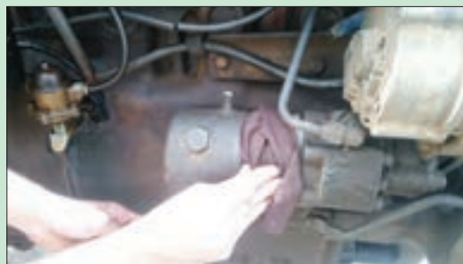
شکل ۴۱-۳ تمیز کردن پوسته روغن فرمان
