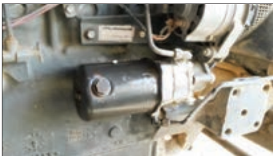
شکل ۴۰-۳ محل بازدید روغن پمپ فرمان تراکتور فرگوسن ۲۸۵
