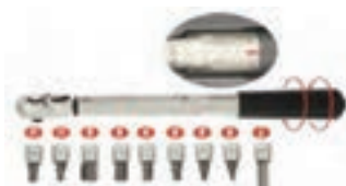
شکل ۱۴-۱ تنظیم ترک متر قابل تنظیم
