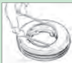
شکل ۲۵-۵ جدا کردن تایر از رینگ یک تکه
