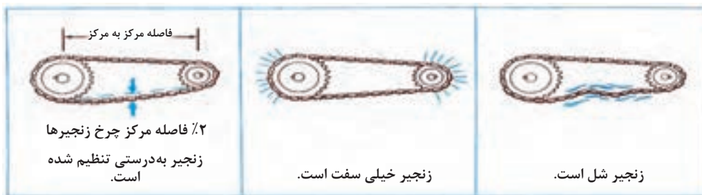
شکل ۱۱-۲- کشش زنجیر
