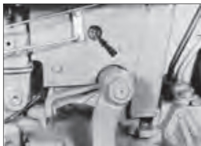
شکل ۳۹-۳- بازدید سطح روغن جعبه فرمان تراکتور ۲۸۵
